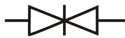
Вариант 4. Знак "Задвижка клиновья или шиберная". Шаровой кран так обозначать неверно, но обозначают так часто.
