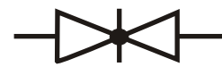
Вариант 5. Знак "Задвижка клиновья или шиберная". Шаровой кран так обозначать неверно, но обозначают так часто.
